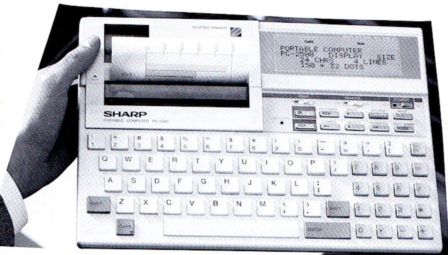
PC-2500: Vierfarben Plotter-Drucker, RAM-Karten, Große LCD-Anzeige, Funktionstasten, Serieller E/A-Anschluß, große Tastatur, Cassettenrecorder-Schnittstelle und eingebaute Software
